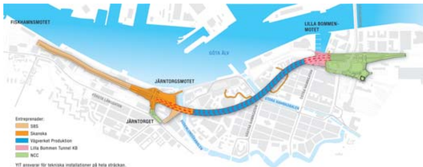
Projekt Götaleden omfattar sträckan från Fiskhamnsmotet till tunnelträget öster om Götaälvsbron. Kartan visar inom vilka områden huvudentreprenörerna arbetar. Bergtunneln har drivits fram från två arbetstunnlar medan betongtunnlarna byggs i öppna schakt.
